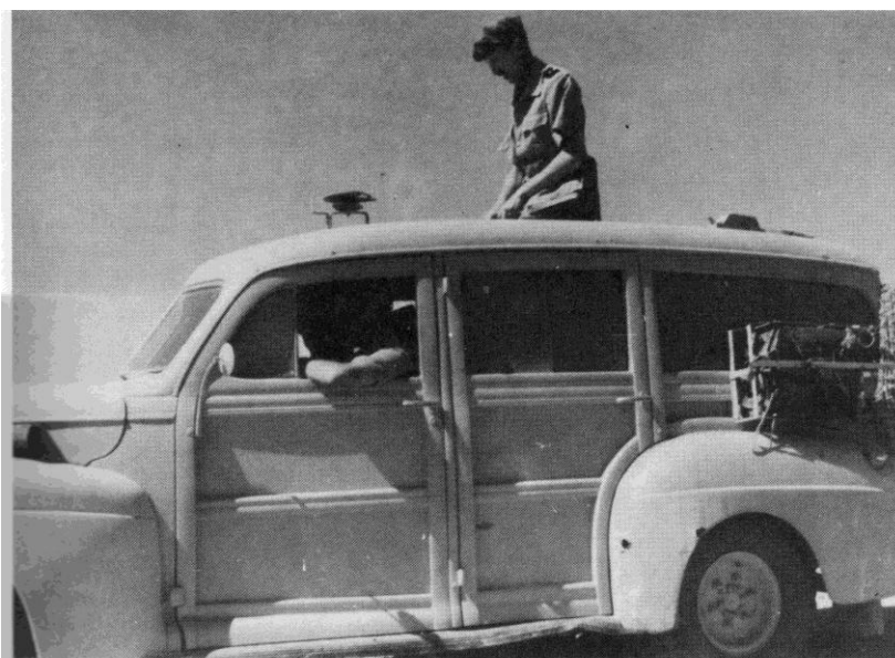
Le général Koenig à bord de sa voiture de commandement. Noter le compas solaire sur le capot du véhicule (photo aspirant J.-P. Bénard).
